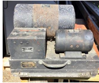
28v Motor Generator 1000v + 230 DC (Bendix)
